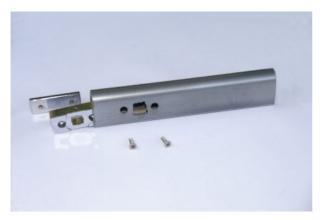
En face des 2 vis, il y a 2 perçages afin de serrer les 2 parties de la poignée originale.
