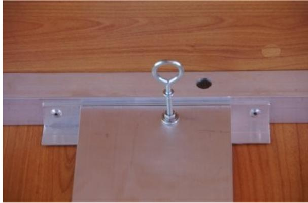
En haut, perçage et rivetage dans le tube carré en aluminium.
