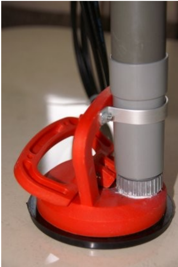
La ventouse de fixation sur le toit.
